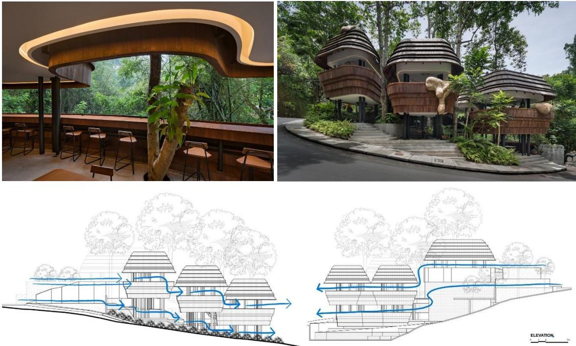
Gambar 4: Struktur elevated yang mendukung pergerakan udara vertikal secara optimal, sehingga tercapai sirkulasi alami tanpa penggunaan AC
