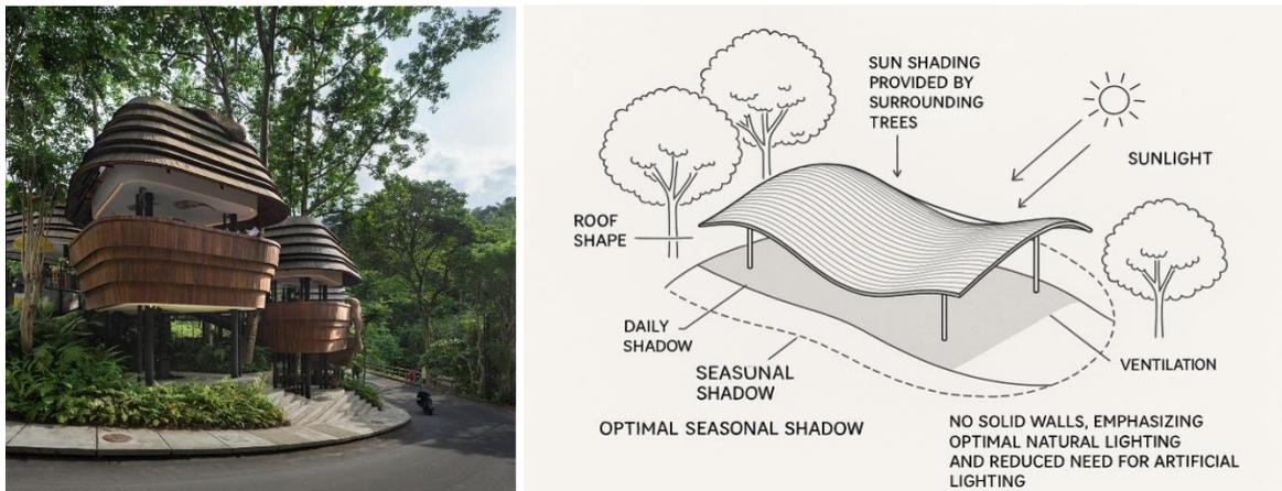
Gambar 5: Struktur WYAH Ubud yang menunjukkan integrasi dengan alam dan penggunaan material alami seperti kayu sirap untuk menciptakan ventilasi optimal
